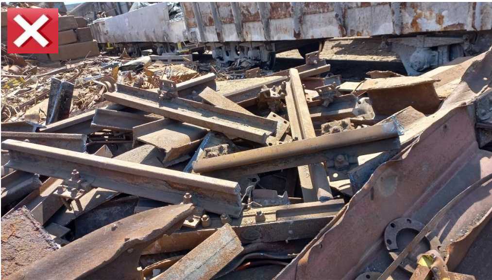
Obr. 3 – Kolejnice spojené s podkladnicemi
