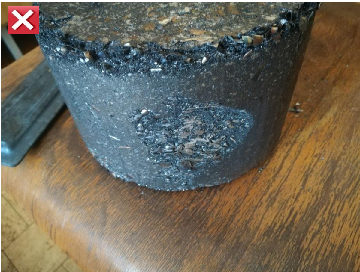
Obr. 19 – Obyč. briket tříška – ztráta hmoty vybroušením (více pojiva než samotné třísky)
